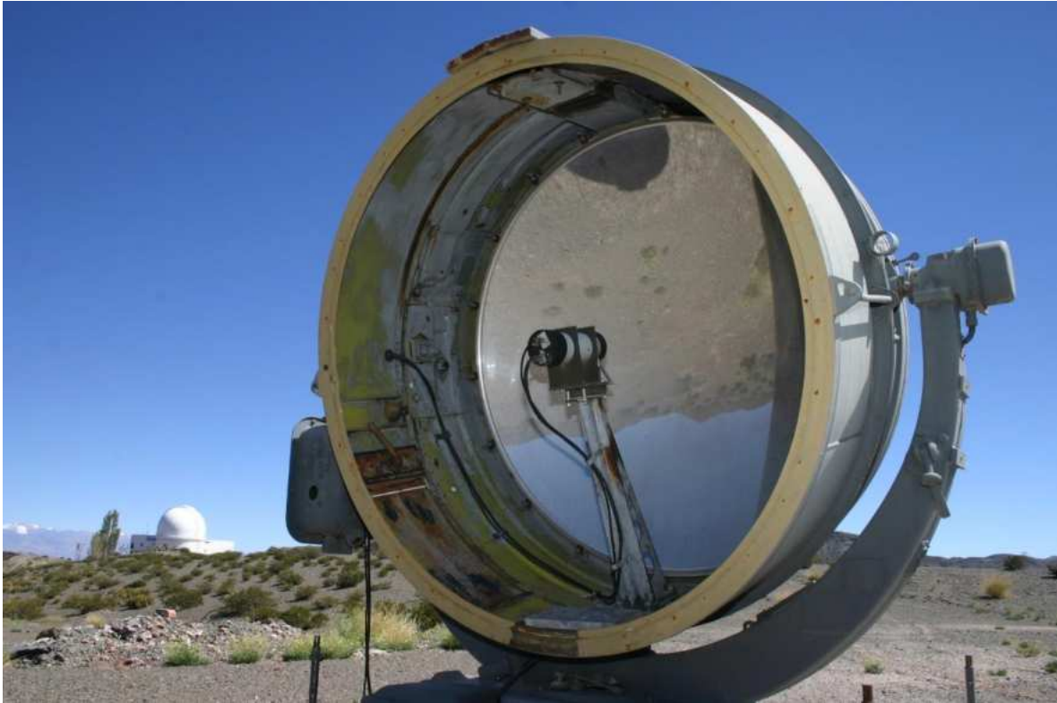
Figura 331 Detalle de los viejos buscadores de aviones modificados para detectar radiación Cherenkov
