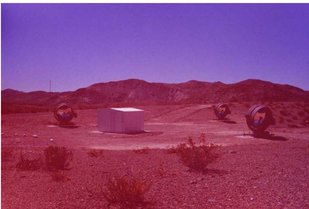
Figura 330 Los tres telescopios ubicados en los vértices del triángulo. La casilla metálica contenía las computadoras de control
