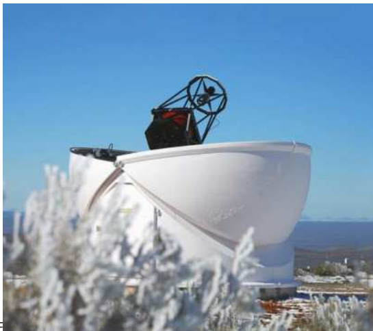
Figura 327 Así se abre la cúpula dejando a solaris 4 al descubierto para operar
