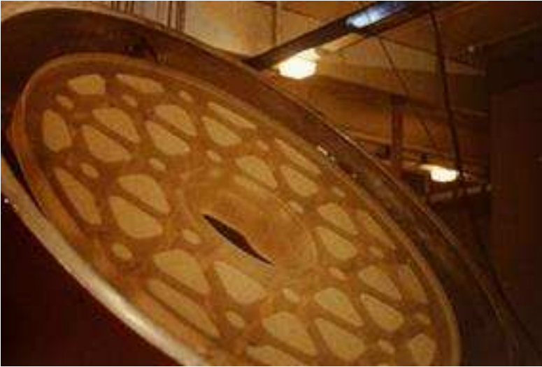
Figura 272 Espejo ubicado en la tapa de la campana de aluminizado
